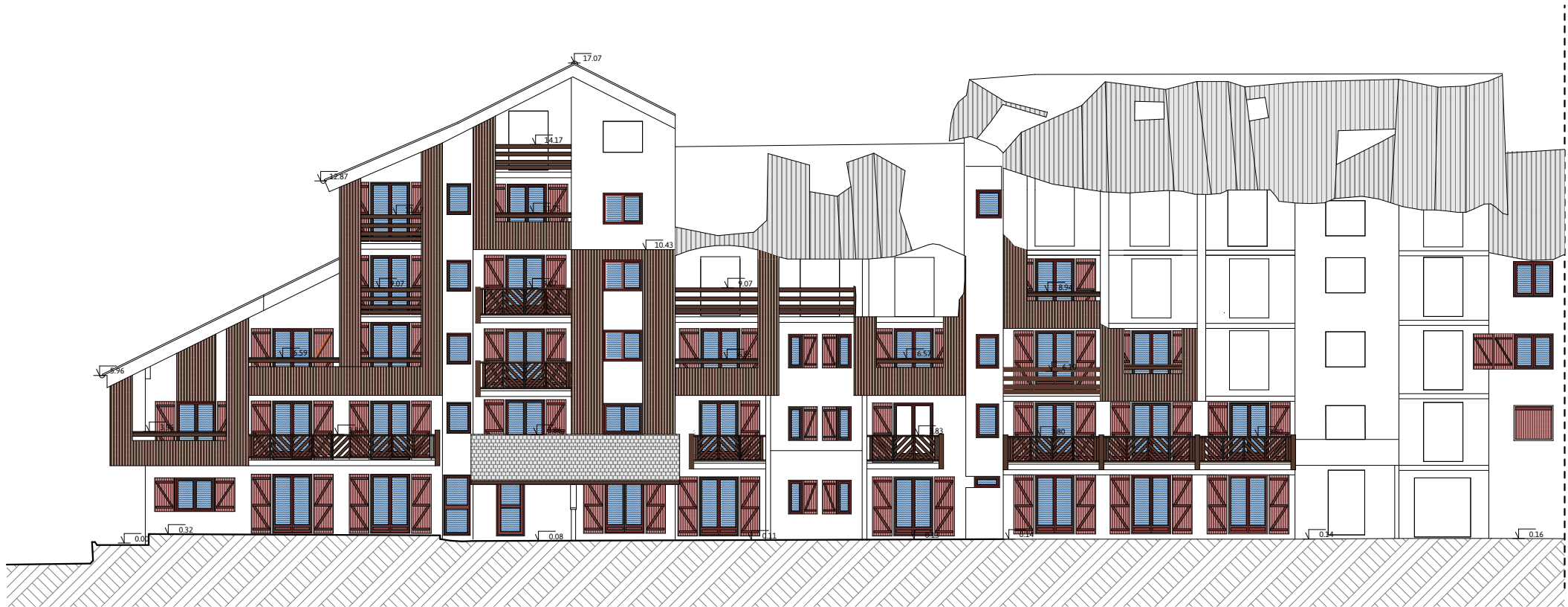
FAÇADE NORD APRÈS SINISTRE
